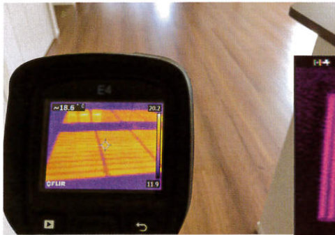
実際のフローリング仕上床でのサーモグラフィ
