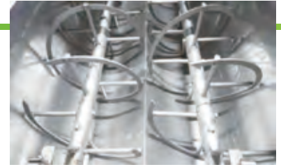
特許取得のスクリュー2本がオガクスを効率よく攪拌します。
