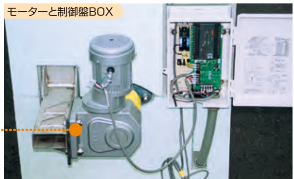
■モーターと制御盤BOX モーターと制御盤は粉塵と湿気・落雷に要注意です。
