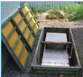
■備長炭が汚水を浄化します(SG500型は60kg)
