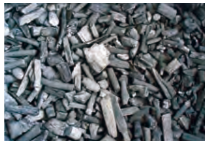
■備長炭が汚水を浄化します(SG500型は60kg)
