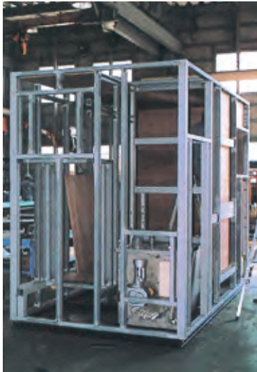
■鉄骨フレームにバイオトイレが内蔵されています。
