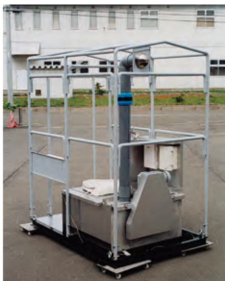
■ 軸組立完了 巾1,200×奥行1,800×高さ2,100、重さ420
