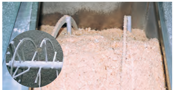
強化スクルーには数々の特許が使われています。圧力に耐える工夫と隅部の攪拌、全体の攪拌効率とデットスペースの解消等の特長を有しています。
